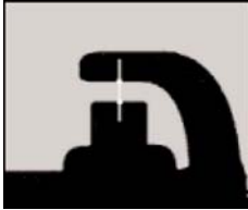
Figura 6. Uso de la detección de bordes para medir la luz de una bujía.
