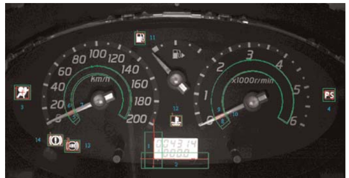
Figura 2. Imagen de la secuencia de ensayo sobre la imagen del panel.
