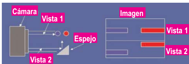
Figura 2. Usando una cámara para alinear dos ejes.
