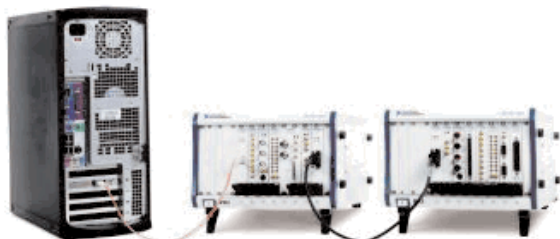
Figura 4a. Control remoto con MXI-4 permite el control de un PXI desde una PC de mesa así como también de sistemas de chassis PXI múltiples.
