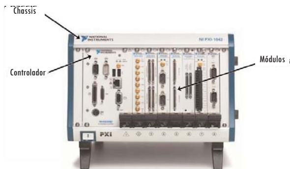
Figura 1. Un chasis PXI estándar de 8 ranuras contiene un controlador embebido y siete módulos periféricos.
