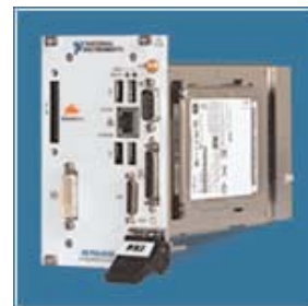
Figura 5. Controlador incorporado PXI NI-8105 con procesador 2.0 GHz Intel Core™ Duo T2500. Obsérvese los periféricos familiares de las PC, tales como conectores para teclado/ratón y monitor así como también el disco rígido, USB 2.0, puertos Ethernet y serie, y otros periféricos estándar. Puede ejecutar el S.O. estándar Windows 2000/XP o bien LabVIEW Real-Time.
