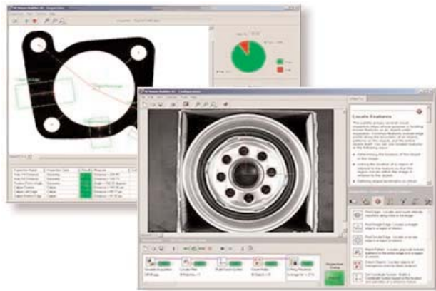
Figura 9. Medición de piezas con el módulo IMAQ Vision
