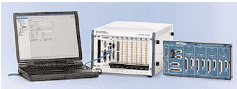
Solución para control de movimiento basado en Ethernet desde una computadora portátil: controlador PXI-8176 ejecutando LabVIEW Real-Time con un controlador de movimiento PXI.
