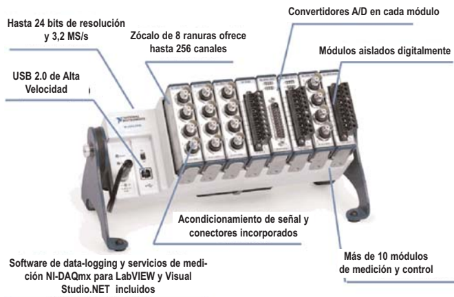
Figura 1. NI CompactDAQ incluye USB DAQ, acondicionamiento de señales, y conectividad a sensores con hasta 256 canales en un sistema de 25 por 9 por 9 cm.
